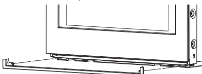
1. Installation affleurante de la garniture inférieure
